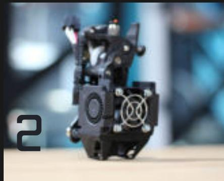
Druckkopf mit NanoXtruder und Phaetus Dragon UHF Hotend welches eine deutlich gesteigerte Durchflussleistung aufweist und sehr gut geeignet ist für Faserverstärkte Materialien
