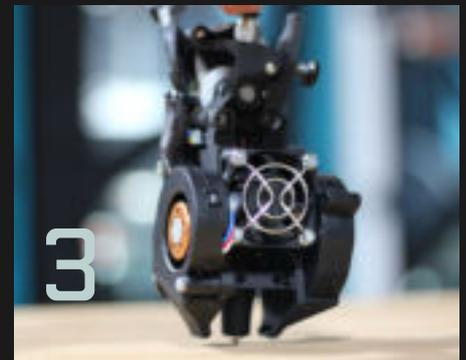
High Performance Druckkopf mit NanoXtruder und Goliath Hotend mit einer extrem hohen Aufschmelzleistung und sehr starker Kühlung ermöglichen Düsendrößen bis hin zu 1,8mm
