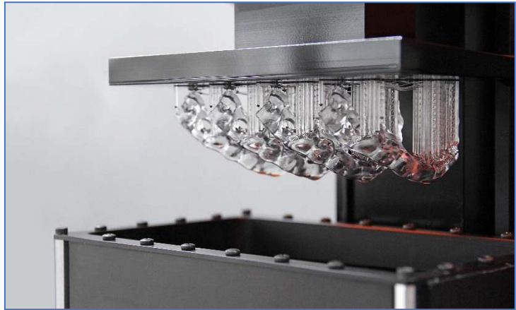
Diese Knirscherschiene wurde aus EnvisionTEC's klarem Material E-Guard hergestellt. In Schräglage gedruckt, gewinnt das Bauteil deutlich an Präzision.
